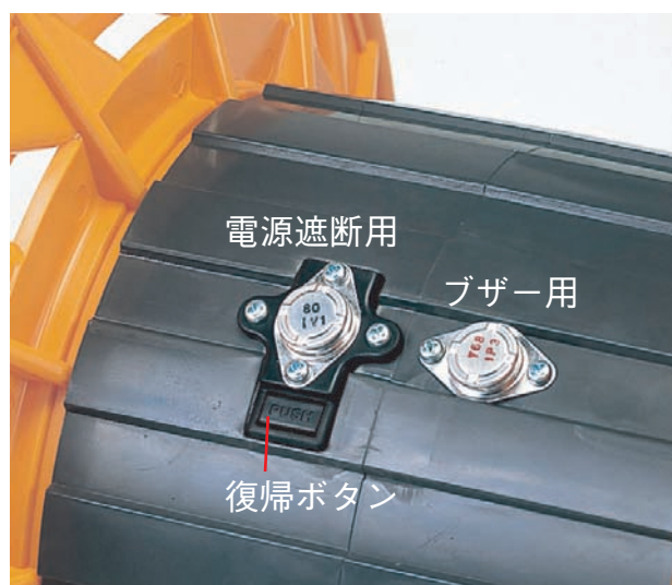
ブザーが鳴ってから電源遮断をするタイプ
