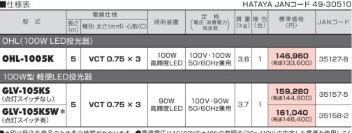
●\*印は受注生産品のため多少納期がかかります。●電源電圧はAC100Vの±10%の範囲内(90~110V)の安定した電源を使用してください。●落下防止ワイヤー付 ●発電機を使用する場合はインバーター式を使用してください。●LED光源にはばらつきがあるため、LED光源毎に発光色・明るさが若干異なる場合があります。●本製品は仮設用です。施設照明用途には使用しないでください。●200V で使用する場合は必ず有資格者の方がプラグ交換または配線工事を行ってください。また必ずアース接続を行ってください。
