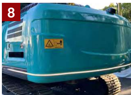
重機取り付け 後方への注意喚起として
