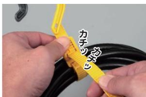
ベルトを固定孔(B)に入れてカチッと締め付け結束します。ストッパー(A)を押してベルトを引っ張ると、締め付けの調整ができます。
