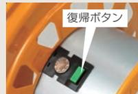
⚠ 注意 温度センサーが作動したら、接続している機器のプラグを抜き、電線を全長引き出します。電線温度が下がり、復帰ボタンを押してパイロットランプが点灯したら再び使用できます。
