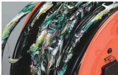
過電流によって溶解した電線(溶解実験写真)
