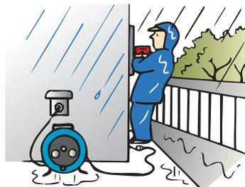
●定格電流は電線を巻いたままの状態で使用できる電流です。(電線を全て引き出した状態で使用できる限度電流については187ページをご覧ください。) ●円盤 / 鉄板製 ●本体: コンセント防雨キャップ付 二次側: コンセント防雨キャップ付 ●ブレーキストッパー付 ●漏電遮断器については193ページをご覧ください。
