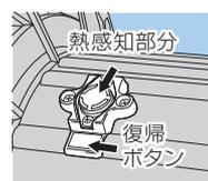
傷(ヘコミ)があると温度センサーが正常に作動しない場合があります。温度センサーは本体中筒部に設置してあります。ケーブルを全長引き出して点検してください。温度センサーが作動して電源が遮断された場合、電源ランプが消灯しますので必ず接続されている機器のスイッチを切り、差し込みプラグをコードリールから抜いてケーブルを全長引き出してください。
