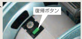
⚠ 温度センサーが作動したら、接続している機器のプラグを抜き、電線を全長引き出します。電線温度が下がり、復帰ボタンを注意 押してパイロットランプが点灯したら再び使用できます。
