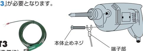
電動工具本体が樹脂製でドリルビットと導通があり、本体止めネジが奥にあるタイプにはメタセンアダプター「**MSB-AB3**」が必要となります。
