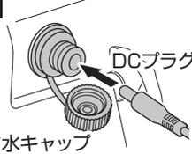
灯体背面の防水キャップを開き、ACアダプターのDCプラグを本体に接続します。
