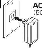
ACアダプターをコンセント (AC100V 50/60Hz) に接続します。
