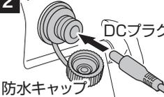
灯体背面の防水キャップを開き、ACアダプターのDCプラグを本体に接続します。
