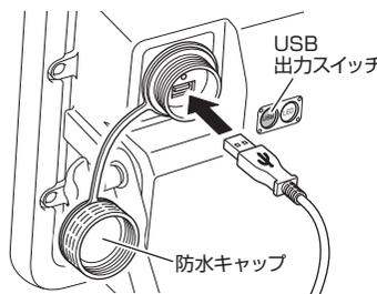
灯体背面左側の防水キャップを外し、USB出力スイッチを押してから、USBポートにUSB端子を挿し込んでください。バッテリー残量インジケータで電池残量が確認できます。
