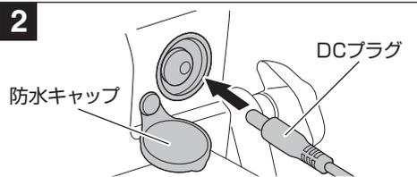
灯体背面の防水キャップを開き、カープラグのDCプラグを本体に接続します。
