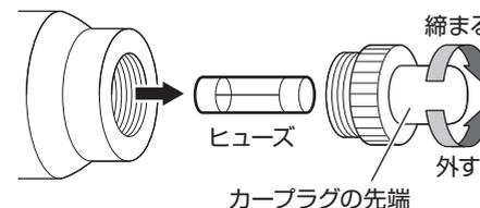
カープラグを接続して、充電されない場合はカープラグ内のヒューズが切れていないか確認してください。ヒューズが切れていない場合は、再度カープラグをソケットに挿し込んでください。
