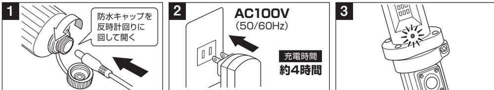
1 グリップ下部の防水キャップを開き、ACアダプターのDCプラグを本体に接続します。
