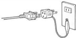
2 アーステストボタンを押してください。アースチェックランプ(グリーン)が点灯すれば、アースは安全です。点灯しない場合は、電源がアースが不完全です。もう一度電源を確認してください。
