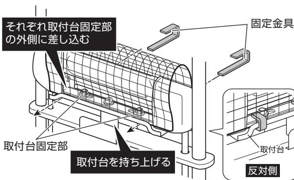
**4** 固定金具をペンチなどで折り曲げ、固定します。
