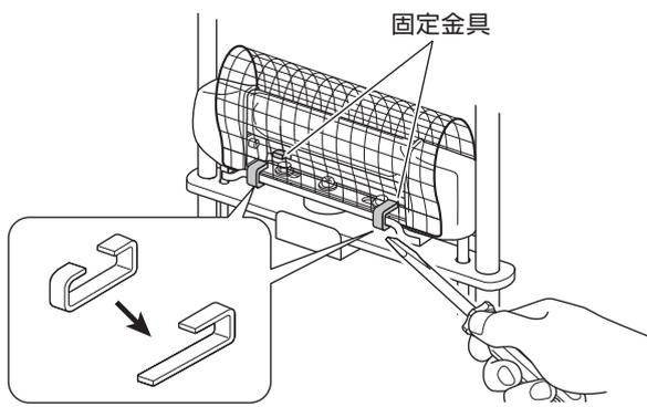
**2** 固定金具を引き抜くと保護ネットを取り外せます。
