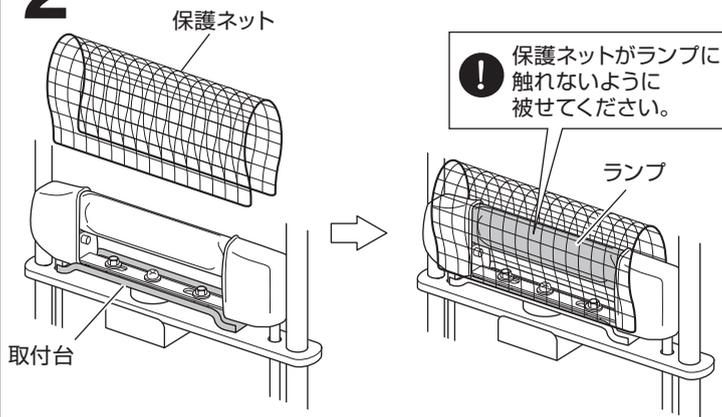
**3** 固定金具を取付台固定部のビスより外側にそれぞれ差し込み、保護ネットと取付台をはさみ込みます。(2箇所)
