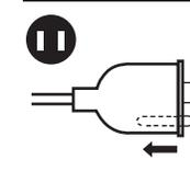
アースピンのロックを解除して差し込みます。アースピンはプラグ内に押し込まれます。
