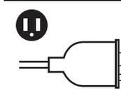
アースピンをロックして差し込みます。アースピンはコンセントの接地極に挿入されて接続されます。
