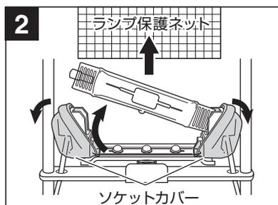
ランプ保護ネットを取り外し(別紙参照)、両側のソケットカバーをめくり上げ、ランプを左右どちらかに押しソケットから外し、新しいランプと交換してください。
