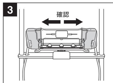
新しいランプを取り付けた後、ソケットカバーを元の状態に折り返し、ソケットに確実に取り付いていることを確認してください。確認後、ランプ保護ネットを取り付けてください。
