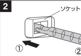
ランプを左右どちらかに押しながら手前に引き、ソケットから外します。逆の手順で新しいランプを取り付けてください。
