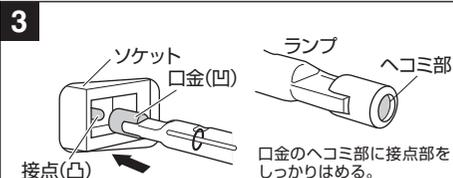
新しいランプを取り付けたら、ソケットの接点部にランプの口金が確実に取り付いていることを確認してください。
