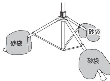
三脚スタンドを設置する場合、安定の良い平坦な場所に垂直に設置してください。風の強い場合は転倒防止の為、下部に砂袋などで倒れ止めの処置を必ず行ってください。
