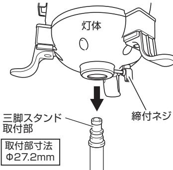
! 三脚スタンドに取り付けて使用する場合は安定した地面に垂直になるように設置し、また屋外使用時で風の強い日は特に注意し、砂袋等のおもりで十分な転倒防止の処置を図ってください。
