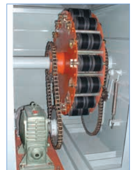
トルクコントロールユニット部
