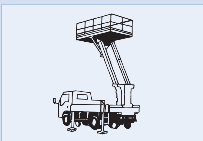
高所作業車等の特殊車両
